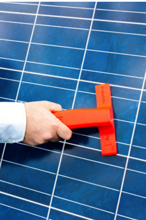
Das rote Handgerät sieht auf den ersten Blick aus wie ein Scheibenabzieher. Tatsächlich ist es aber ein Messgerät, das Solarmodule auf ihre Funktionalität prüft
