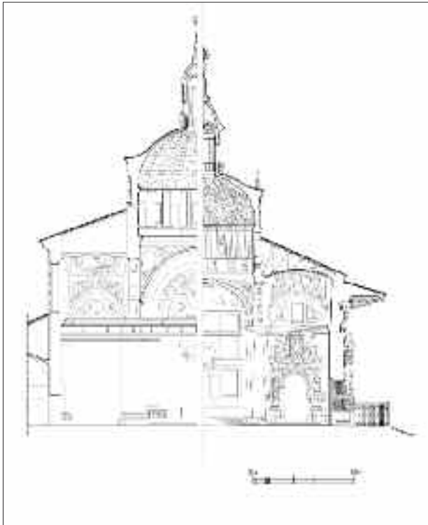
8. Calatayud (Zaragoza). Iglesias colegiales de Santa María y del Santo Sepulcro: a) secciones comparativas de su estado actual, levantadas a través del crucero. Izquierda, Santo Sepulcro, derecha, Santa María; b) secciones comparativas del Santo Sepulcro. A la izquierda, obra construida. A la derecha, restitución, según el condicionado. En trazos rojos, perfil correspondiente a la cúpula tal como se inició, antes de modificarla en obra, para dotarla de tambor. Javier Ibáñez Fernández y J. Fernando Alegre Arbués. Delineación. Manuel Pedruelo. GRUCONTEC S. L.
