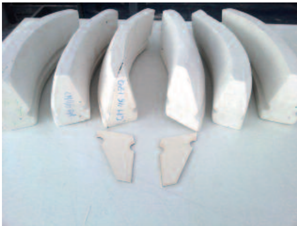
7. Nervios combados en proceso de talla con sus plantillas reviradas, las simetrías y sus reviros a izquierda o derecha añaden insospechadas dificultades en la labra de este tipo de piezas.
