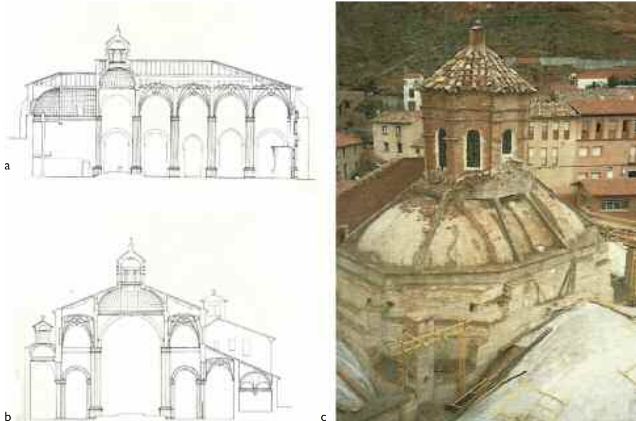
7. Daroca (Zaragoza). Colegiata de Santa María: a y b) secciones longitudinal y transversal, según Fernando Aguerri Martínez y Javier Ibárgüen Soler; c) exterior de la cúpula. Fotografía tomada en 1989, durante la sustitución de las cubiertas del templo. Tomada de La colegiata de Santa María de Daroca y su restauración , Zaragoza 1992.
