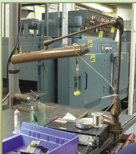
■ ...el proceso de la soldadura real tiene lugar en este horno de soldar por el que los filtros pasan a través.
