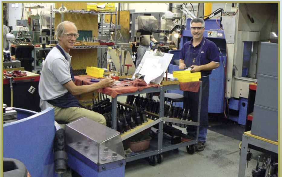
■ En la máquina de corte CNC con Bruce Sentoff (a la izquierda) y Dale Newton (a la derecha). Aquí se producen los cuerpos de muchos modelos de filtros a partir de bloques sólidos. “Nosotros programamos por la tarde las máquinas y después ellas trabajan automáticamente toda la noche”, nos explica Bruce Sentoff.
